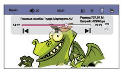
Меню управления автоматически перестает отображаться, если в течение 10 секунд не производить никаких действий.
